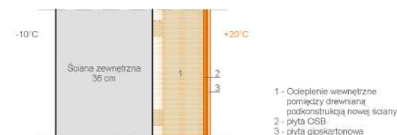
Przegroda budowlana z wewnętrznym ociepleniem
