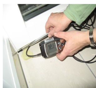
Wskazanie anemometru dla dopuszczalnego przepływu max. 0,2 m/s. Przepływ powietrza w narożniku 1,4 m/s fot. Katarzyna Jaročka
