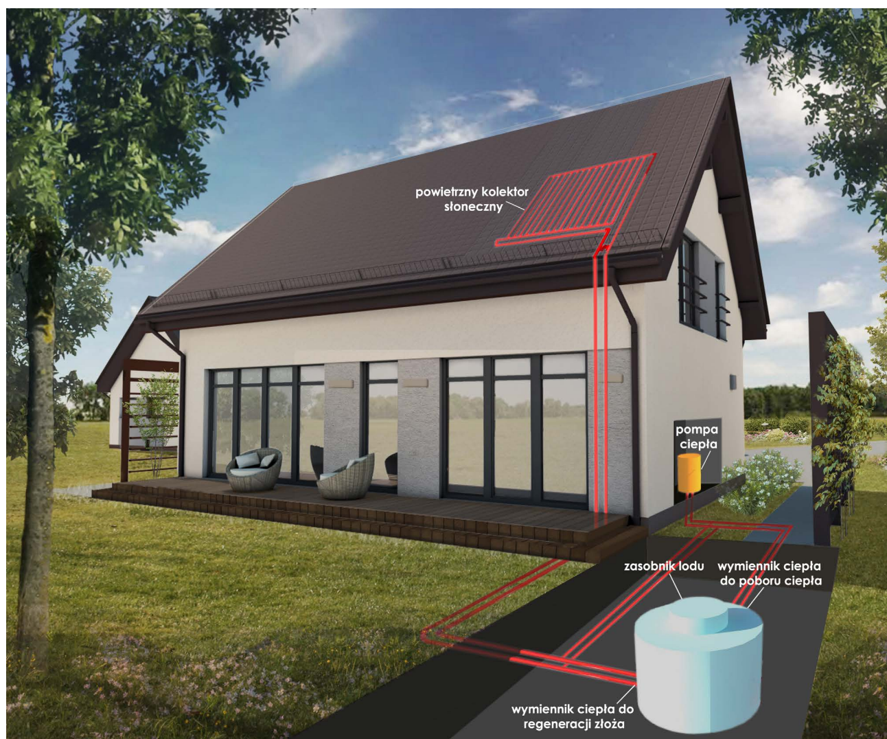
Schemat systemu wykorzystującego energię krzepnięcia
